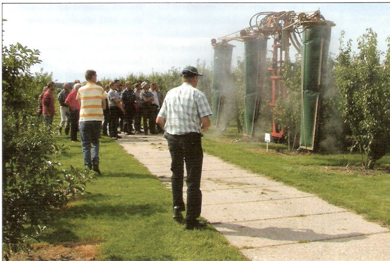
Na de toelichting op de proeven vond een demonstratie plaats van de drierijige spuit van Munckhof. De maatschappij Verhage voert hiermee sinds dit voorjaar de gewasbescherming uit.
